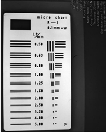
图 1 乳腺模体厚度为 20mm 应用手动曝光模式进行摄影, 辐射剂量为 80mAs 时, 辐射剂量达到 1.5mGy。X 射线用矩形波测试卡仍可观察到 4LP/mm。
