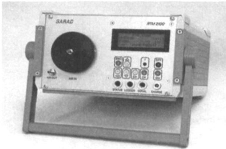
图 1 RTM—2100Rn /Th连续测量仪
